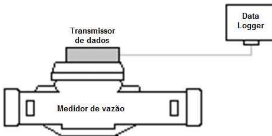
Figura 23 - Esquema representativo da montagem do conjunto de medição.
