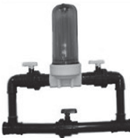
Figura 8 - Dosador de cloro.
