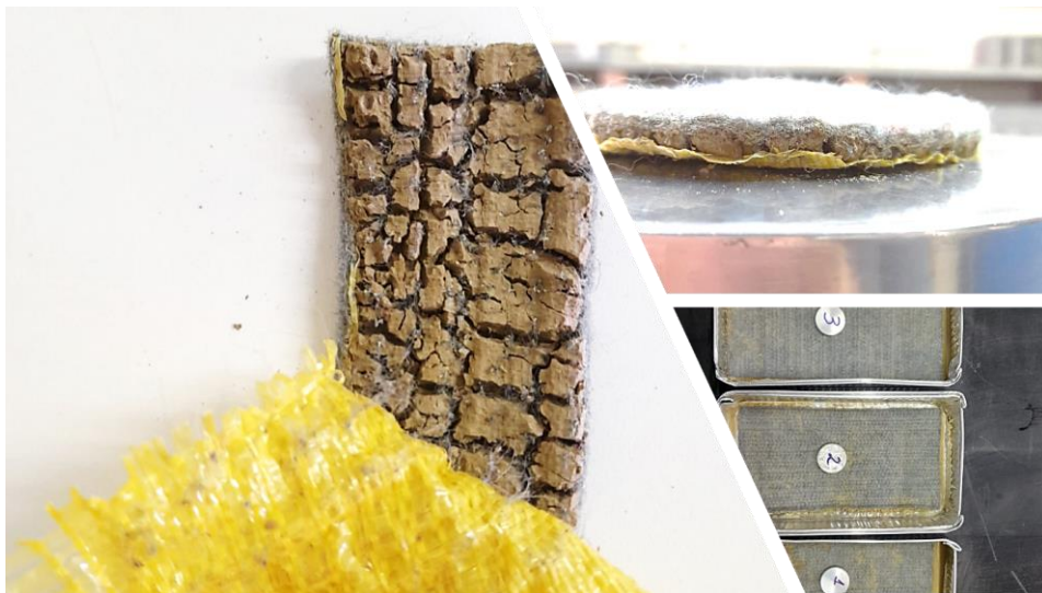
Figura 17: Fissuras em amostras de GCL expostas aos ciclos de umedecimento e secagem.
