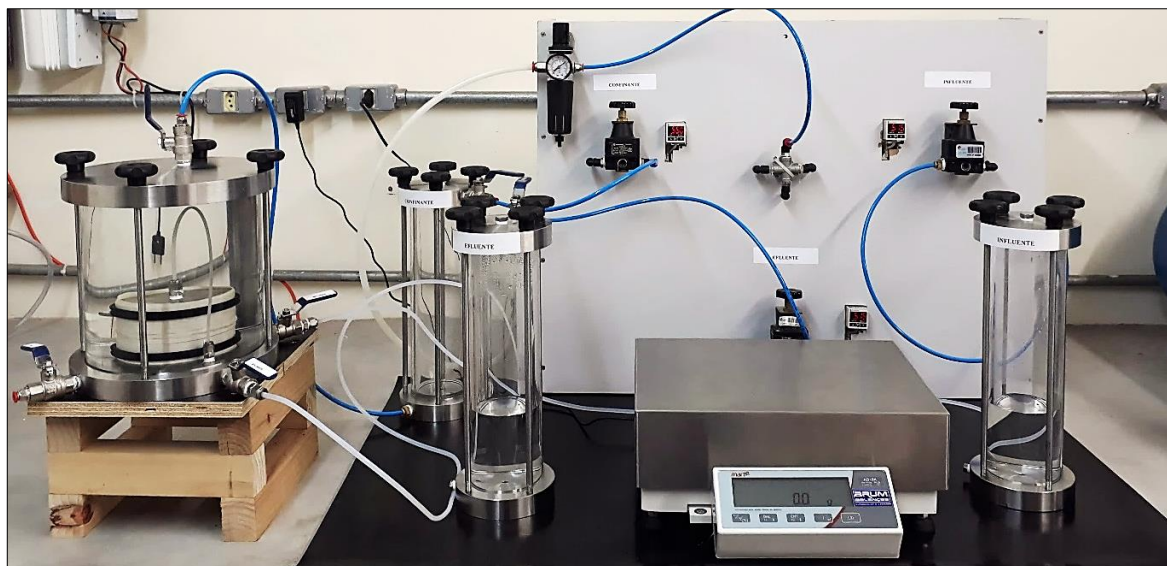
Figura 8: Execução de um ensaio de condutividade hidráulica.
