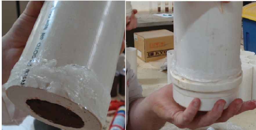
Figura 24: Vedação do cap ao tubo
