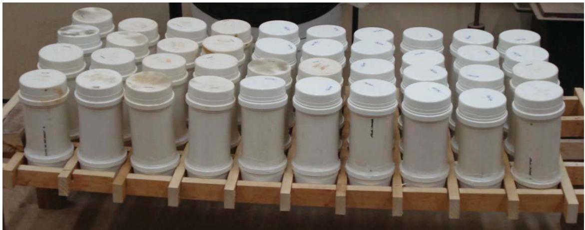
Figura 25: Corpos de prova montados para a aplicação da bioventilação
