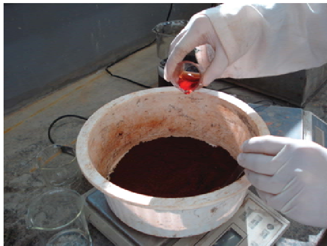
Figura 18: Adição do contaminante
