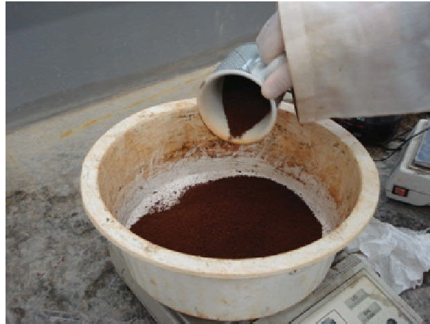
Figura 16: Pesagem do solo
