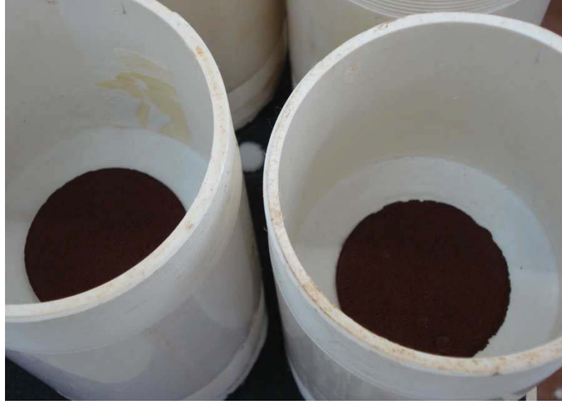
Figura 22: Corpos de prova após o envolvimento com o gesso
