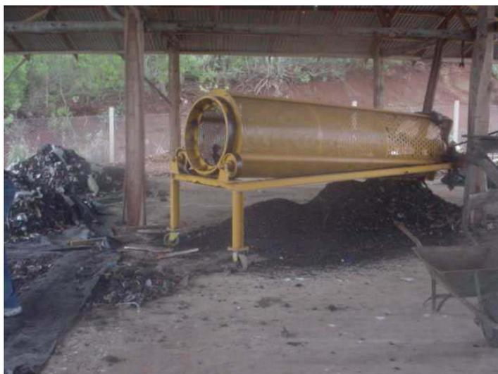
Figura 12 - Peneira rotativa com acionamento elétrico para separação do composto. São Domingos do Sul, RS, 2003.
