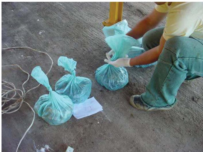
Figura 20 - Coleta das amostras para envio ao laboratório.
