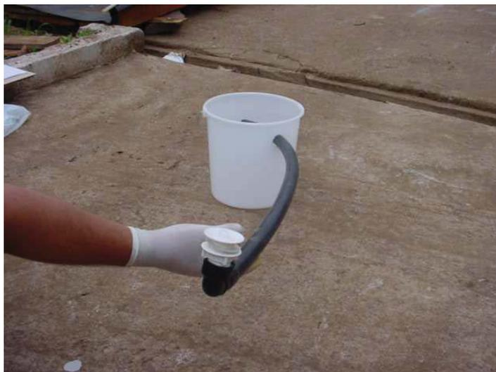
Figura 21 - Sistema de coleta e armazenamento do lixiviado.
