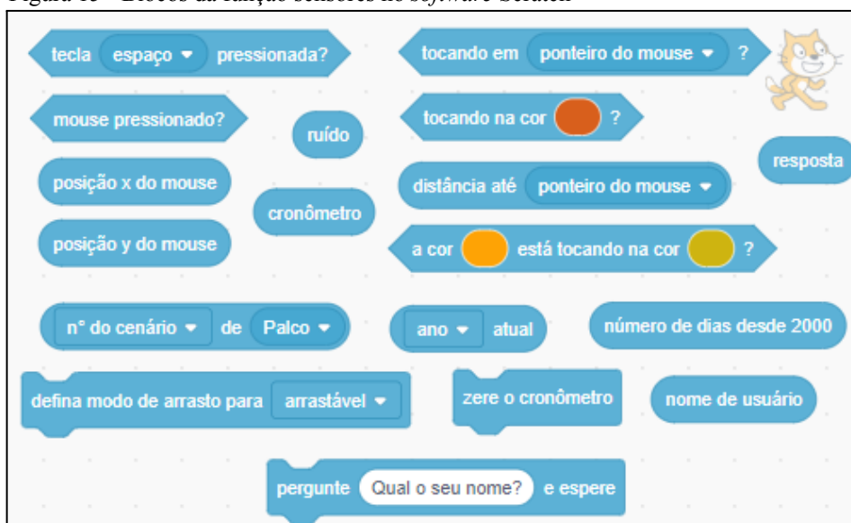
Figura 15 - Blocos da função sensores no software Scratch
