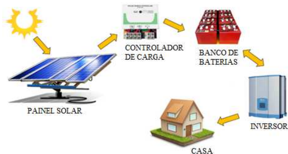
Figura 17 - Sistema isolado ( Off-grid ).
