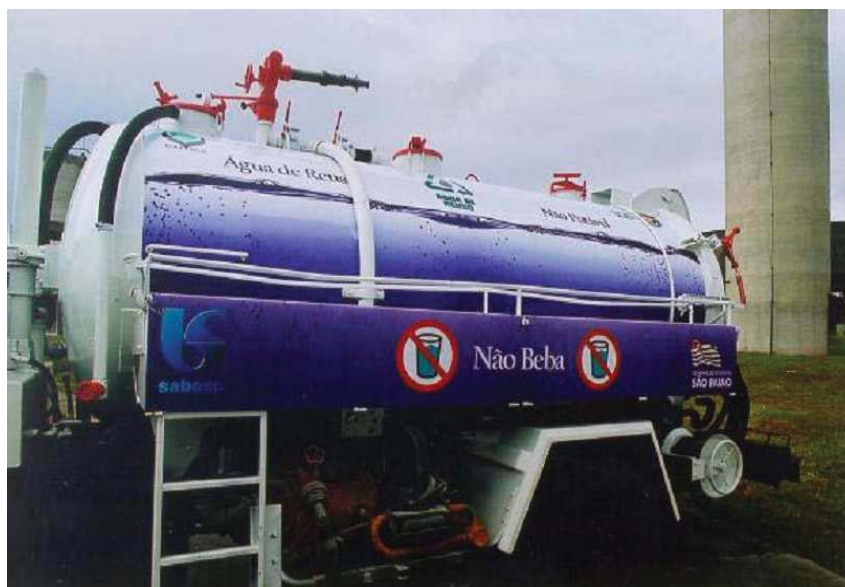
Figura 03 - Caminhão para transporte de água de reúso devidamente sinalizado Fonte: Flório et al. (2002)
