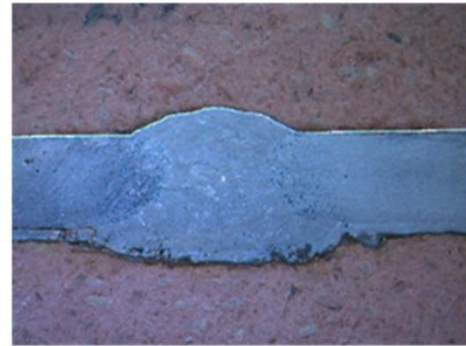
b) Arame Sólido (ER70S-G), gás 80%Ar/20%CO 2 - condição 04
