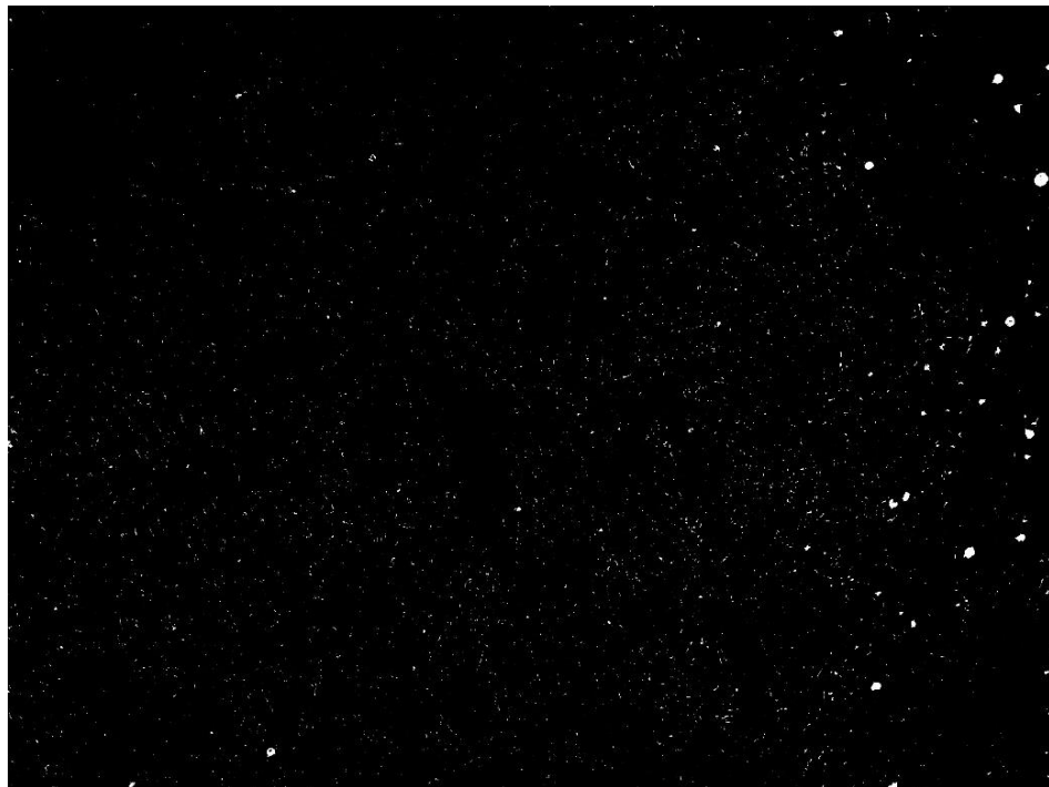
Figura 28 – Porosidade na região de metal adição fundido com arame autoprottegido - amostra 19
