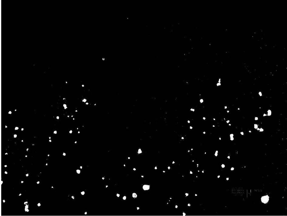
Figura 27 – Porosidade na região de metal adição fundido com arame tubular com proteção gasosa e mistura 92%Ar/8% CO 2 - amostra 10
