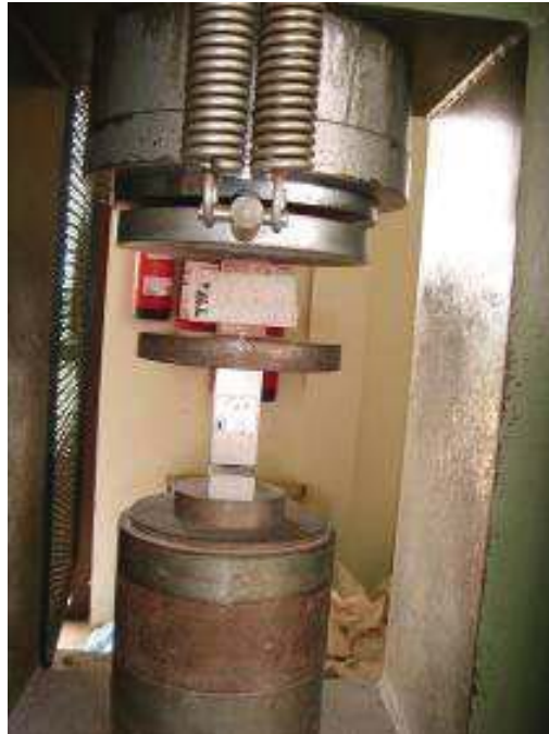
Figura 28: Determinação da resistência à compressão.
