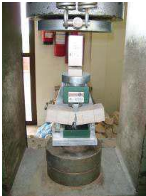
Figura 27: Determinação da resistência à tração na flexão.
