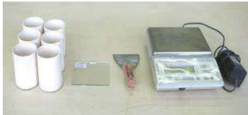
Figura 18: Equipamentos e utensílios para a determinação do teor de ar incorporado.
