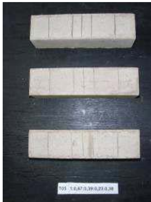
Figura 25: Marcação nos corpos-de-prova prismáticos
