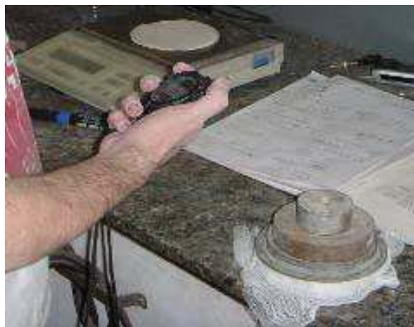
Figura 20: Execução ensaio retenção de água.
