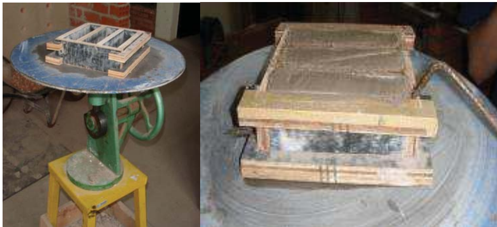
Figura 24: Adensamento dos corpos-de-prova.
