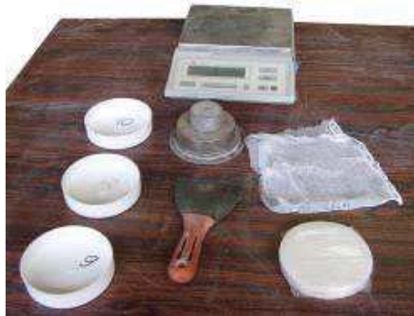
Figura 19: Equipamentos e utensílios para a realização do ensaio de retenção de água.
