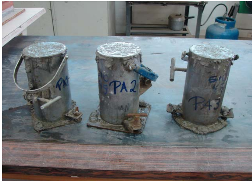
Figura 23 – Corpos-de-prova moldados para obter a resistência à compressão simples.
