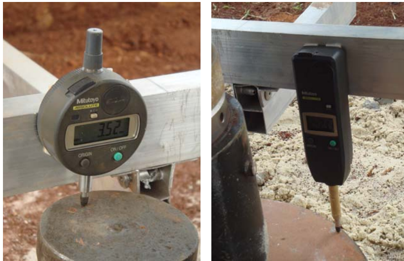
Figura 29 – Deflectômetros utilizados para medição dos deslocamentos.
