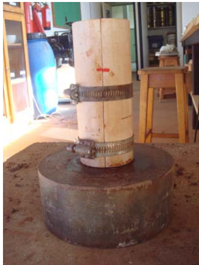
Figura 17 – Molde cilíndrico bipartido para os corpos-de-prova.
