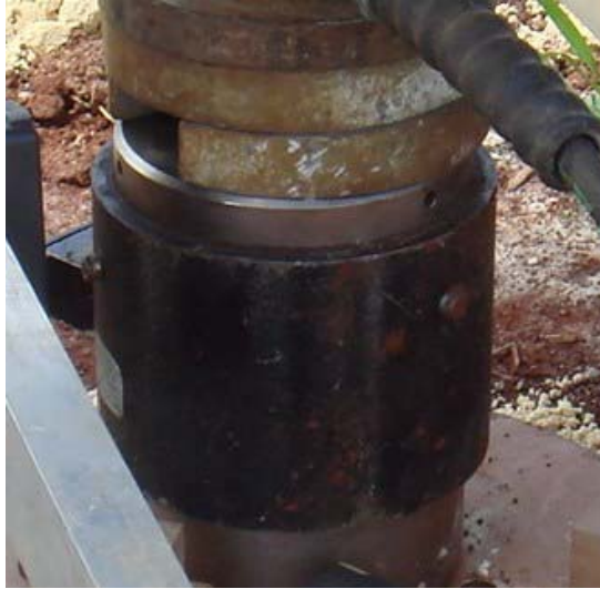
Figura 28 – Célula de carga utilizada como sistema de transmissão de carga.
