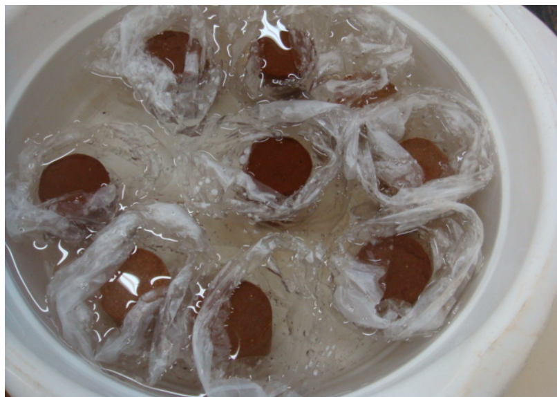
Figura 19 – Corpos-de-prova curados submersos em água por 7 dias em recipiente com temperatura controlada.
