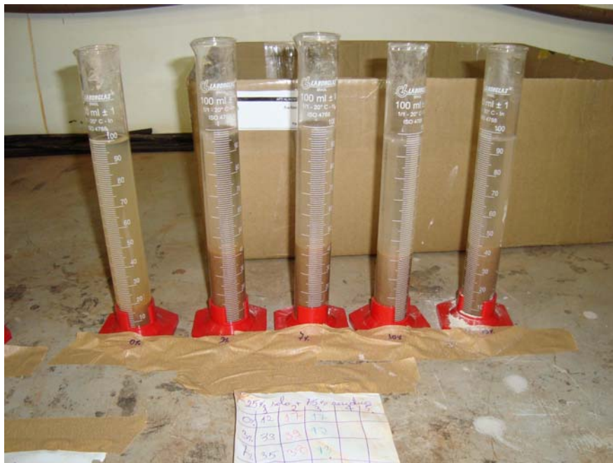
Figura 14 – Provetas graduadas com quantidades previamente determinadas de solo, resíduo, cimento Portland e água destilada.
