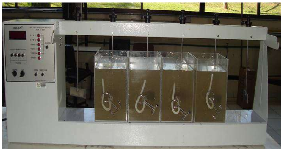
Figura 6: Equipamento Jar-Test contendo efluente antes do tratamento físico-químico.
