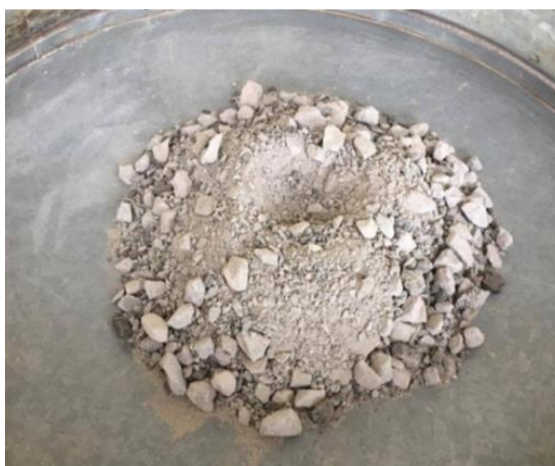
Figura 18 - Mistura dos materiais antes da adição de água no Ensaio Proctor
