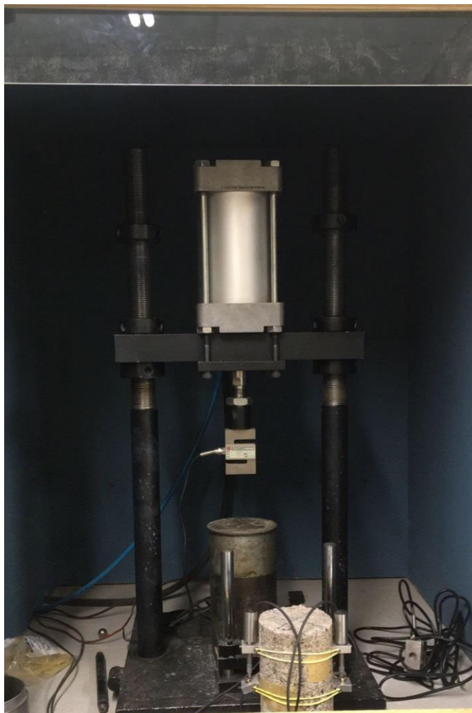
Figura 22 - Equipamento para ensaio de carregamentos cíclicos
