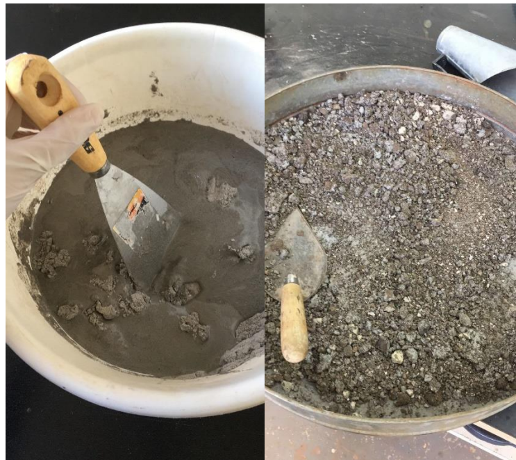
Figura 36 - Mistura dos materiais para cimentação do fresado com geopolímero
