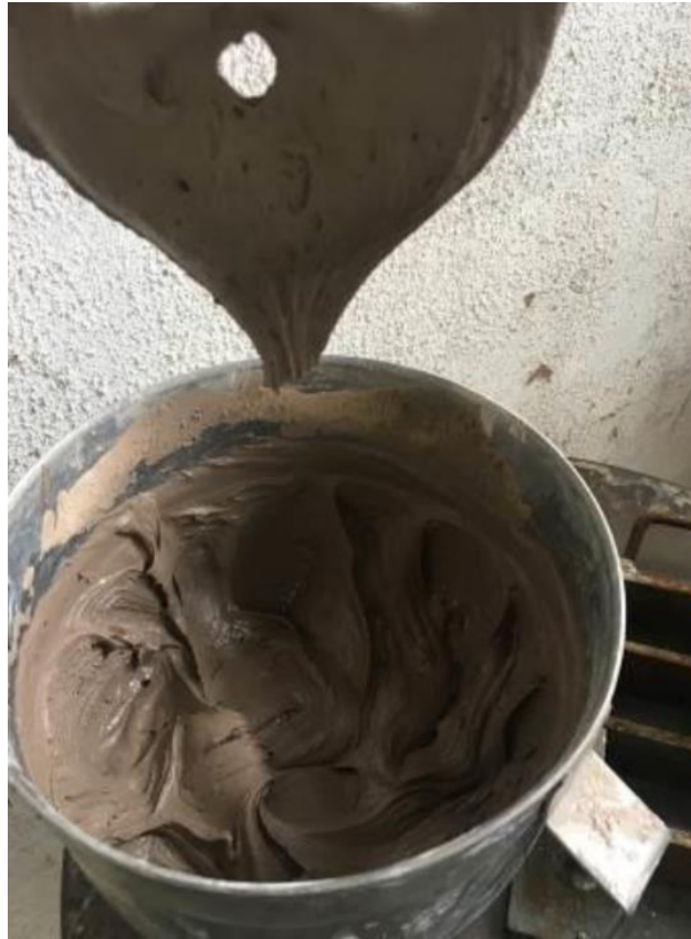
Figura 25 - Aspecto do geopolímero logo após o processo de homogenização
