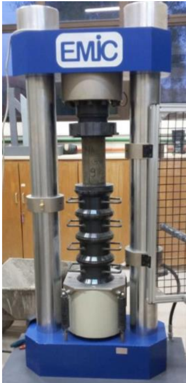
Figura 31 - Prensa EMIC em ensaio de compressão simples
