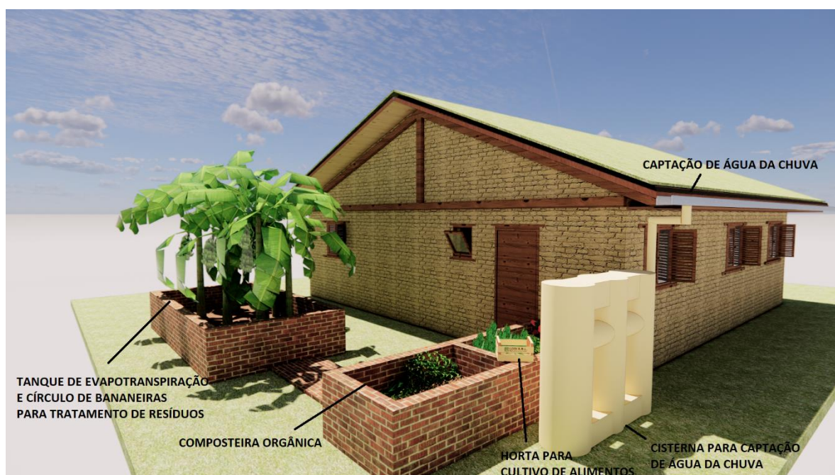
Figura 40- Parte de trás da edificação.
