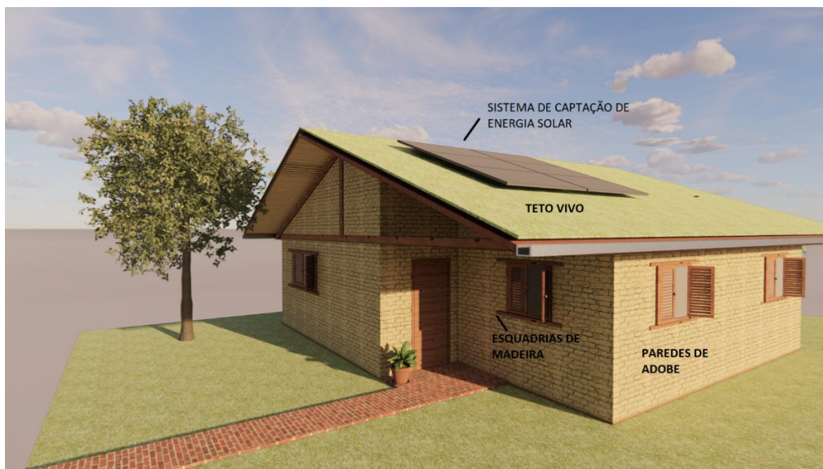
Figura 39 - Fachada/ parte frontal da habitação.
