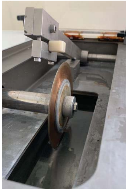
Figura 3 – Bloco de RN sendo cortado em cortadeira sob refrigeração.
