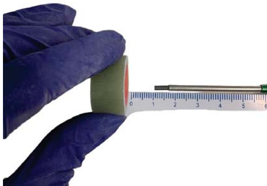
Figura 8 – Distância de 1 cm da ponta do jateador até a amostra.
