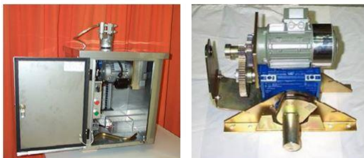
Figura 5 - Mecanismo de acionamento (armário de comando e conjunto motor-redutor)
