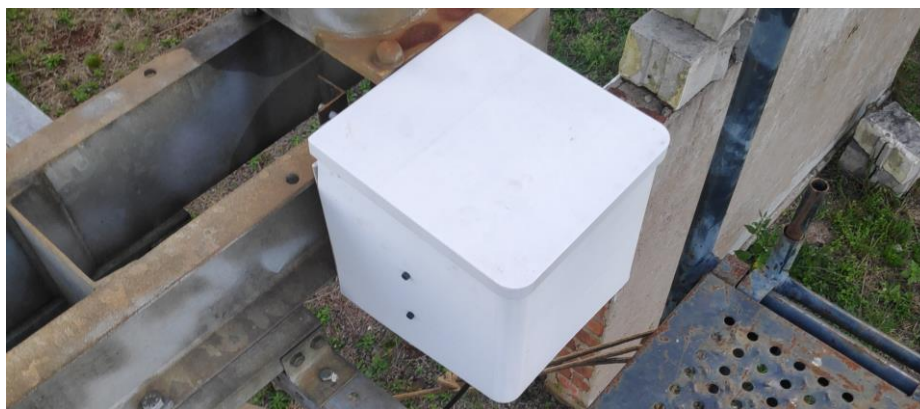
Figura 52 - Motovibrador posicionado com a carenagem de proteção
