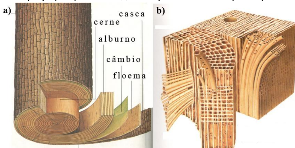
Figura 2 – Composição principal da árvore (a) e ilustração da estrutura de traqueídeos presente nas coníferas (b).
