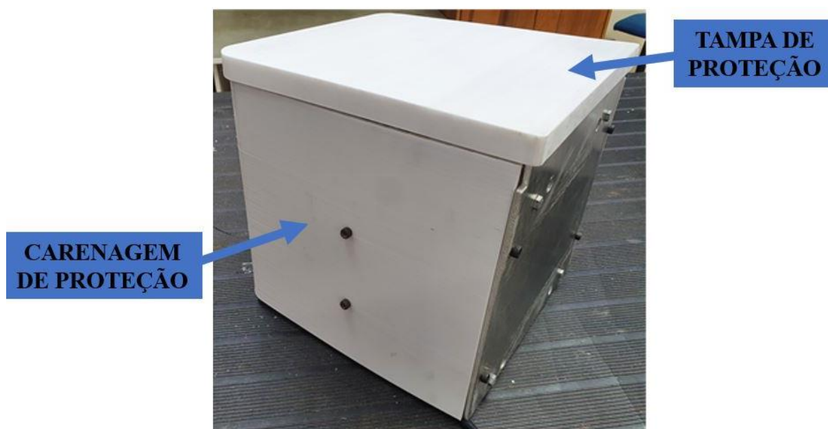
Figura 33 – Carenagem de impressão 3D, em PETG aplicado para os testes em campo
