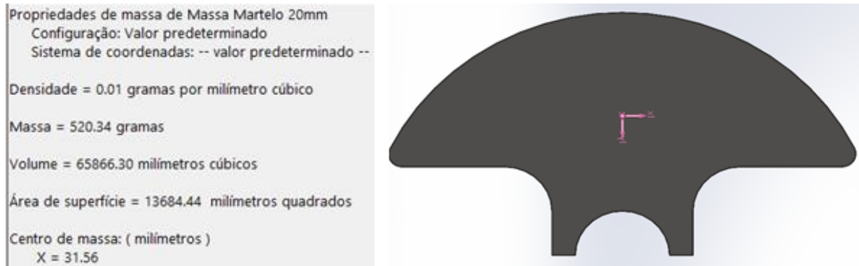
Figura 28 - Segunda nova geometria de massa estilo martelo
