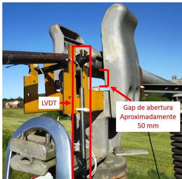
Figura 50 – Ponto de fixação do LVDT e o gap de abertura entre contato fixo e contato móvel
