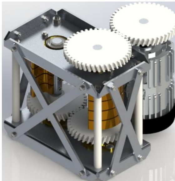
Figura 38 - Perspectiva isométrica da modelagem do motovibrador linear
