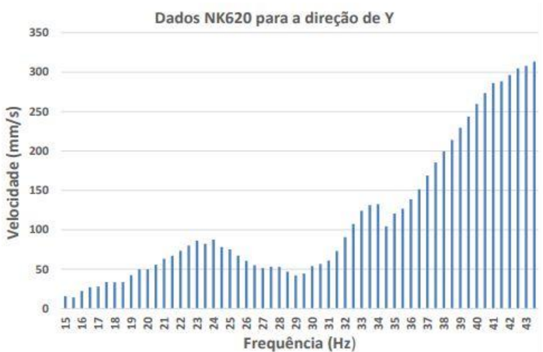
Figura 25 – Gráfico de velocidade x frequência natural (dados NK620)
