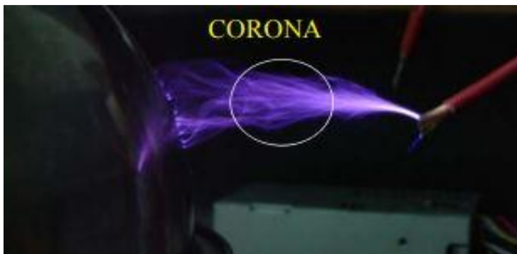
Figura 10 - Efeito Corona pela diferença de potencial elevado
