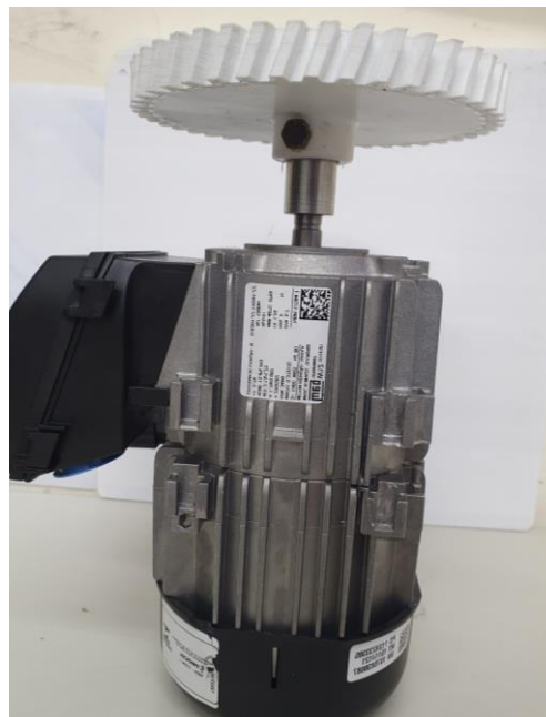
Figura 44 - Montagem dos componentes de transmissão do motor elétrico
