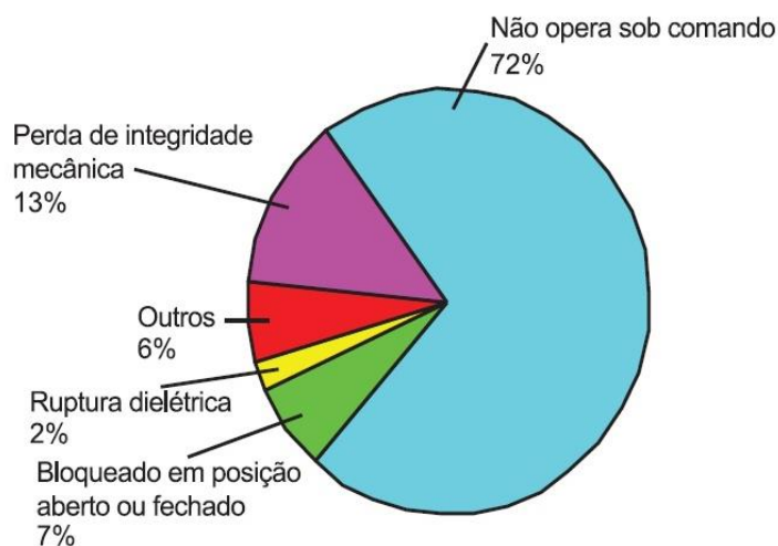
Figura 9 - Tipos de falhas em seccionadores
