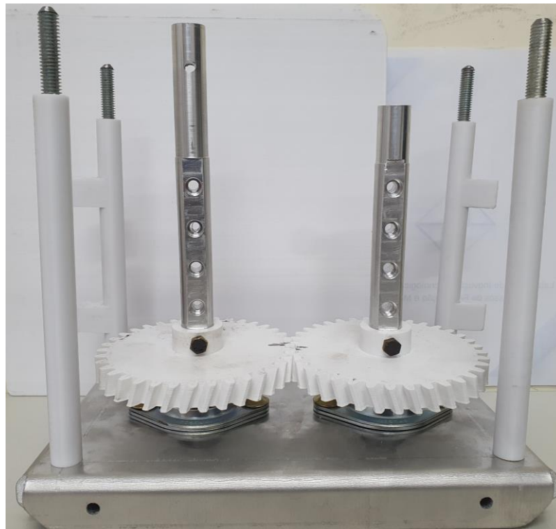
Figura 42 - Inserção dos eixos e espaçadores junto a estrutura
