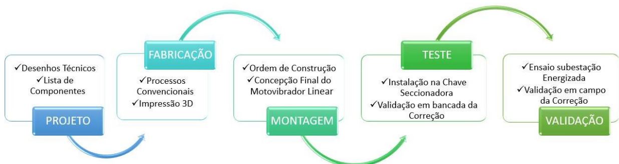
Figura 20 - Fluxograma de etapas para a criação e desenvolvimento do motovibrador linear
