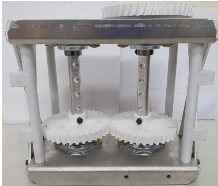
Figura 43 - Continuação da montagem da estrutura do motovibrador linear e adição da engrenagem helicoidal externa
