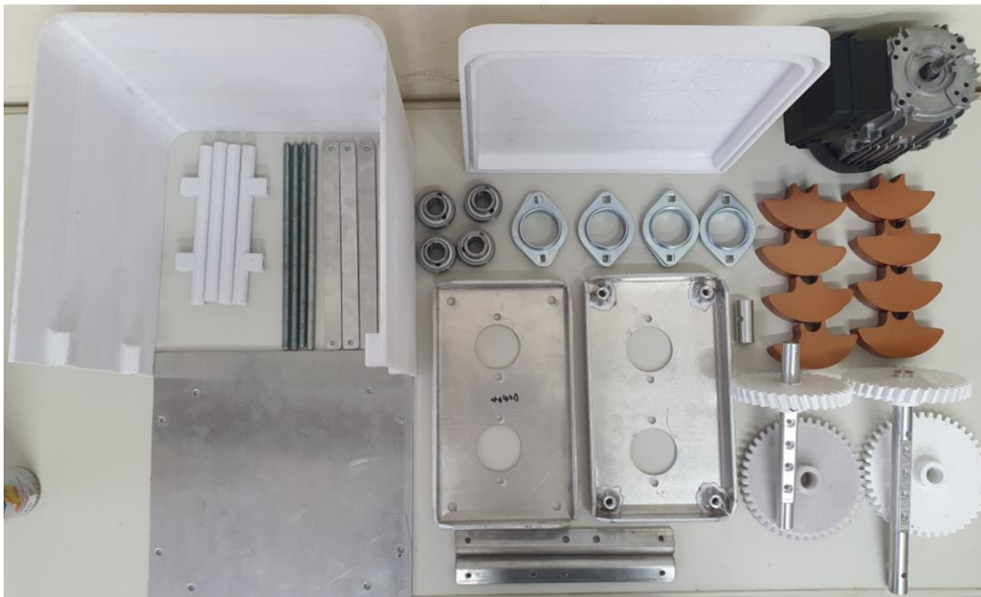
Figura 39 - Componentes atribuídos a montagem do motovibrador linear
