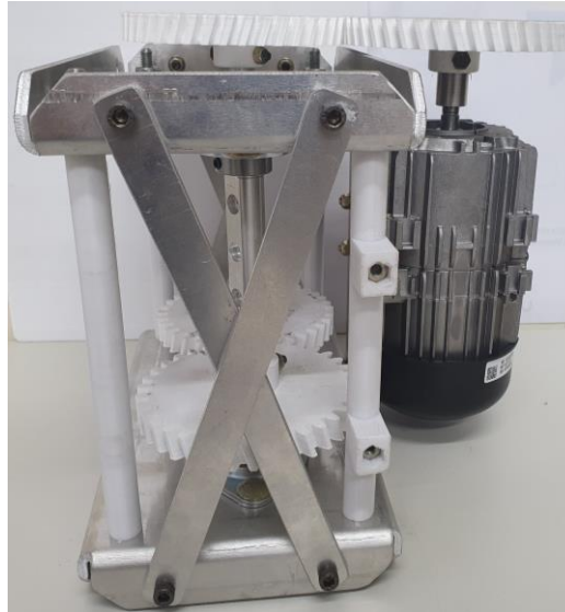
Figura 45 - Incorporação do sistema do motor elétrico com a estrutura do motovibrador linear
