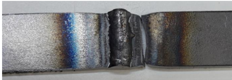
Figura 55 – Fratura do corpo de prova do ensaio de tração com solda.
