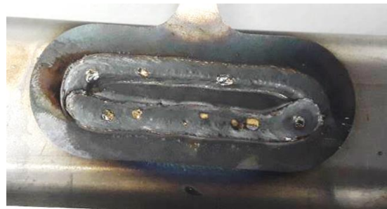
Figura 69 – Uniões soldadas ensaiadas. (a) Solda em ponta. (b) Solda bujão.
