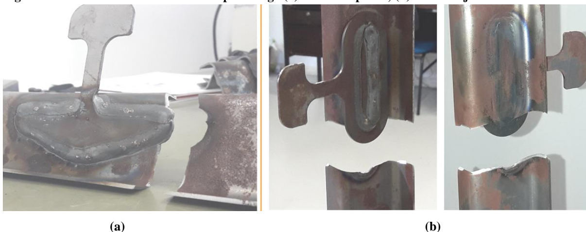
Figura 79 – União soldadas fraturadas por fadiga (a) Solda em ponta; (b) Solda Bujão
