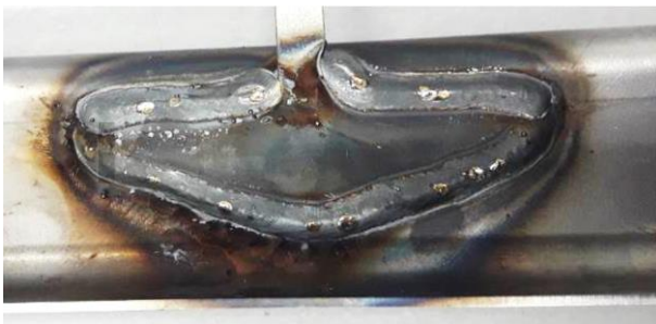
Figura 69 – Uniões soldadas ensaiadas. (a) Solda em ponta. (b) Solda bujão.
