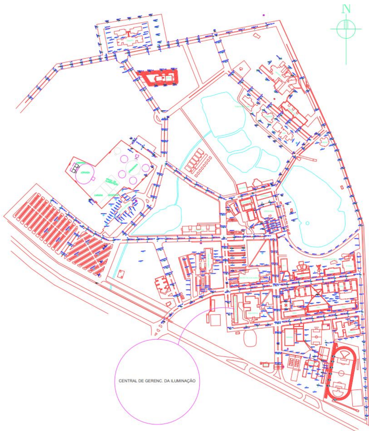
Figura 23 – Planta de distribuição da iluminação externa do Campus I.
