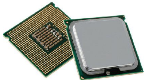
Unidade central de processamento
