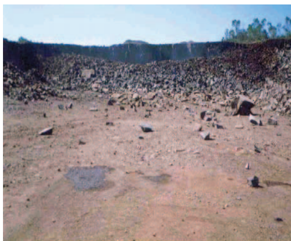
Figura 40 - Pedreira Detonada fase final.
