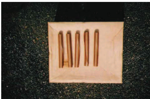
Figura 33 - "Bananas de 1/8" empregadas em pedreiras/ valas.
