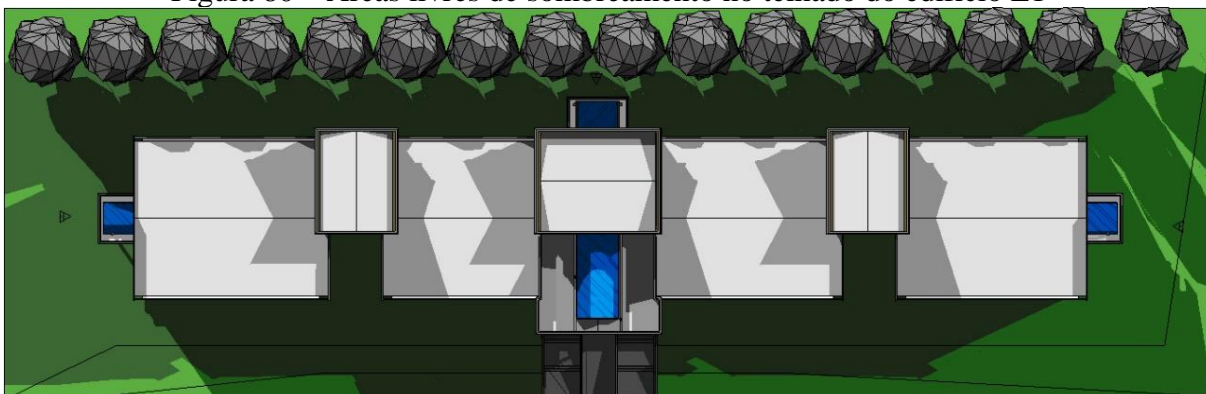
Figura 80 – Áreas livres de sombreamento no telhado do edifício L1
