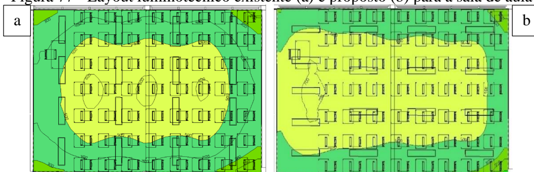
Figura 77 - Layout luminotécnico existente (a) e proposto (b) para a sala de aula
