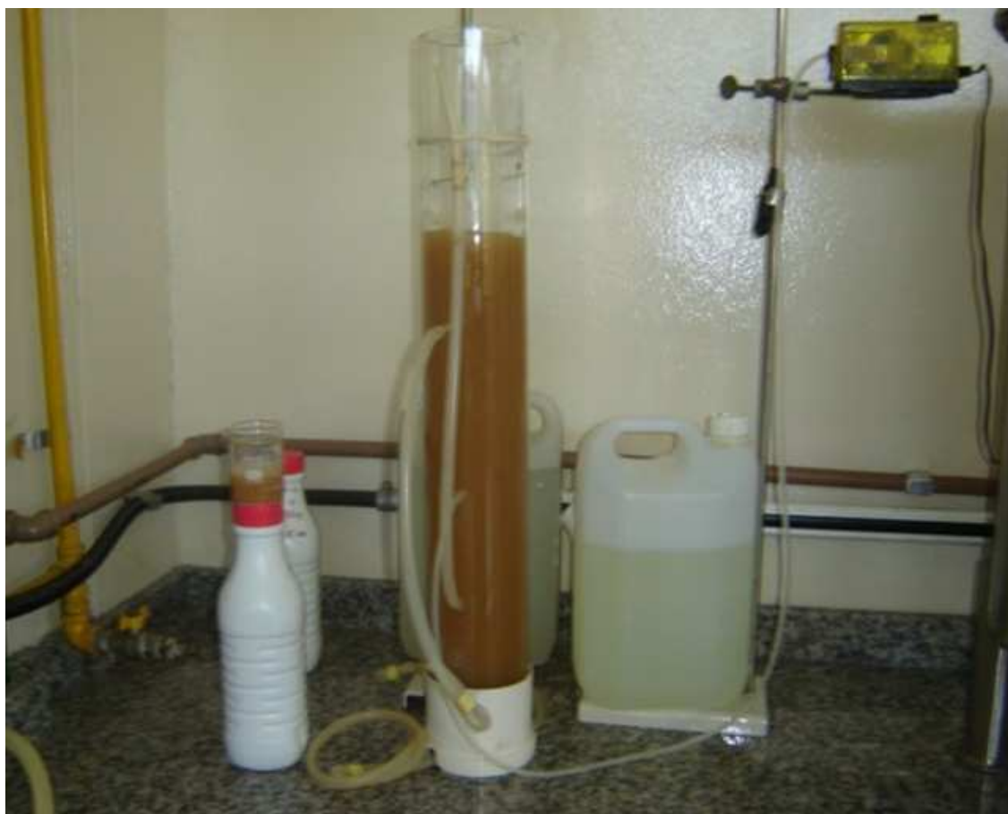
Figura 6: Reator em batelada seqüencial tratando efluente sintético de laticínio.
