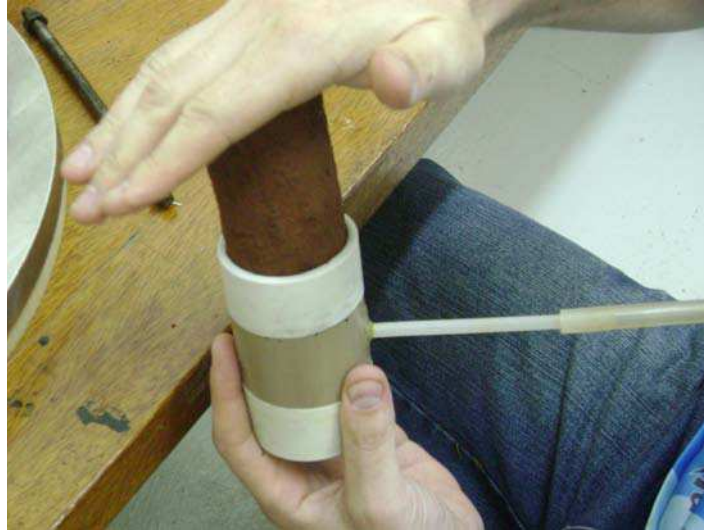
Figura 18 – Colocação da membrana no corpo de prova
