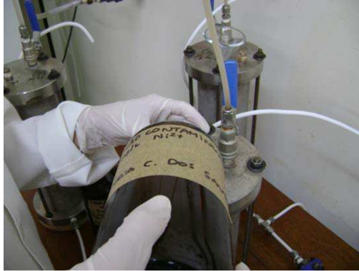
Figura 20 – Adição da solução contaminante nos cilindros do equipamento de coluna
