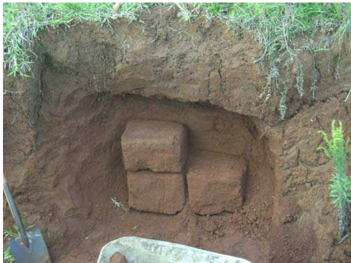
Figura 11 – Moldagem dos blocos de solo na parede da trincheira
