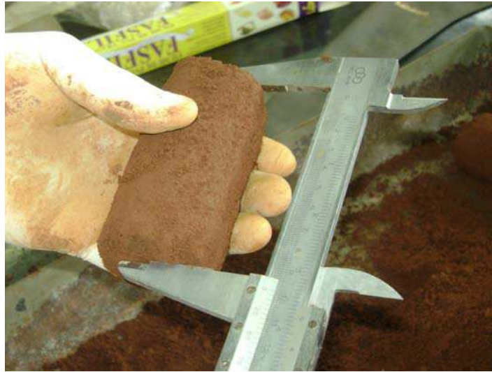
Figura 14 – Medida da altura do corpo de prova com paquímetro
