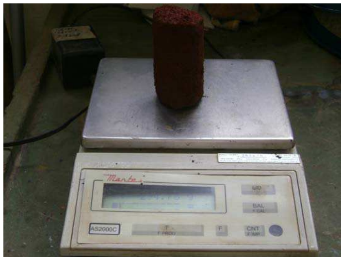
Figura 13 – Medida de massa em balança semi-analítica
