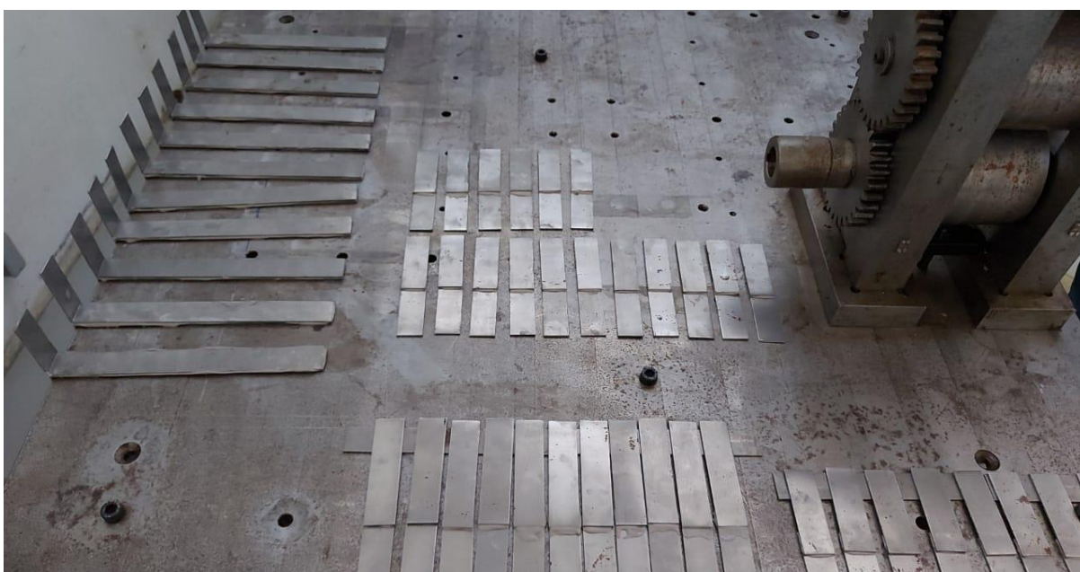
Figura 47: Corpos de prova fabricados para ensaio de cisalhamento
