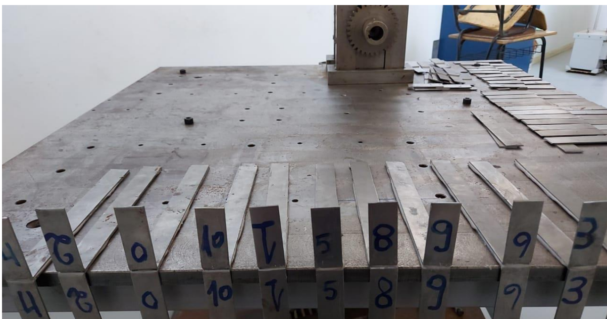
Figura 49: Corpos de prova fabricados para ensaio de arrancamento
