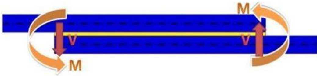
Figura 96: Atuação da força transversal e momento fletor pelo modelo de Goland e Reissner
