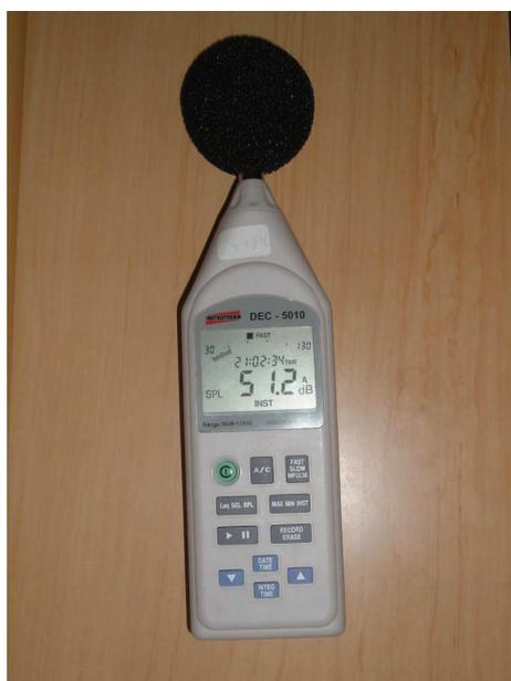
Figura 23 – Sonômetro utilizado nas medições
