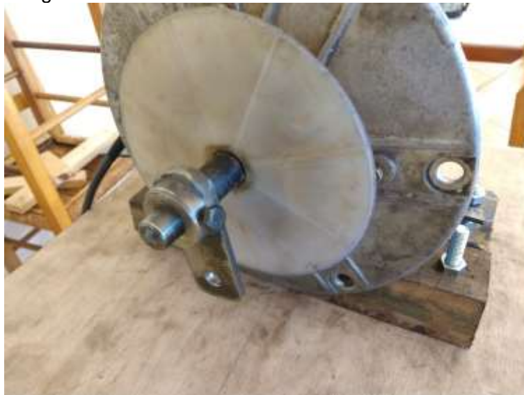
Figura 48: Massa adicionada ao eixo central do motor
