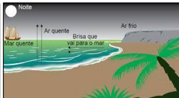
Figura 8 - Movimentação da brisa terrestre durante a noite: a brisa vai do continente (mais frio) para o mar (mais quente).
