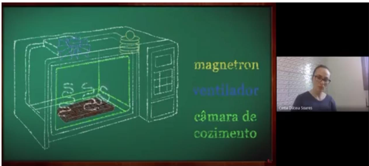
Figura 5 – Print da tela no momento da reprodução do vídeo que explica o funcionamento do microondas.
