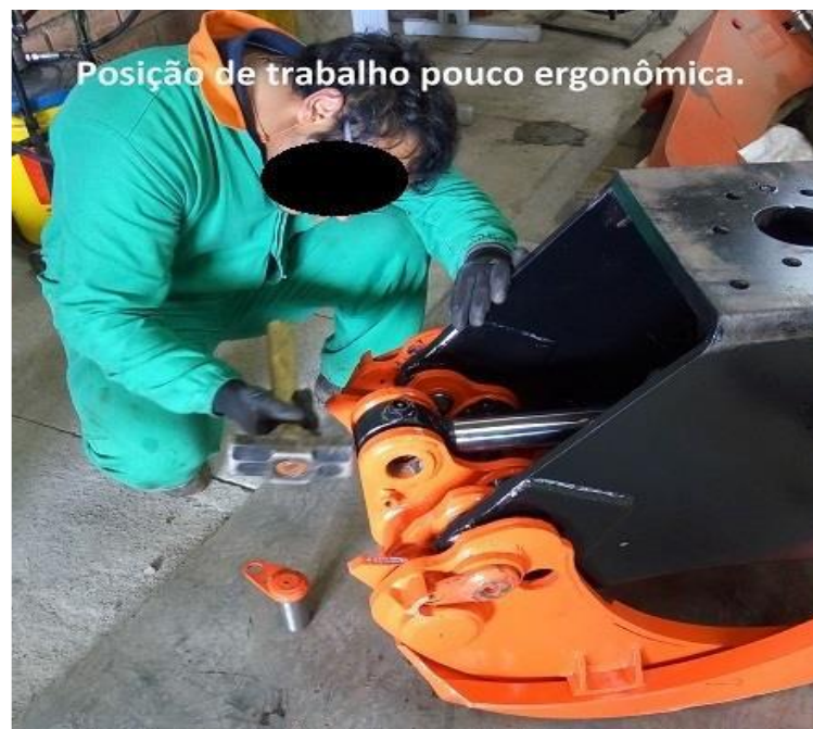
Figura 15 - Montagem de pino em garra florestal.
