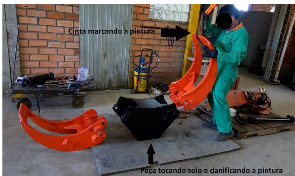
Figura 13 - Montagem de implemento florestal.
