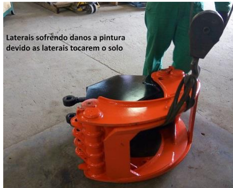
Figura 14 - Garra florestal movimentada com auxílio de cintas de poliéster.
