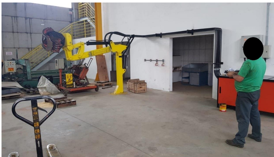
Figura 44 - Garra GJ 300s em montagem.
