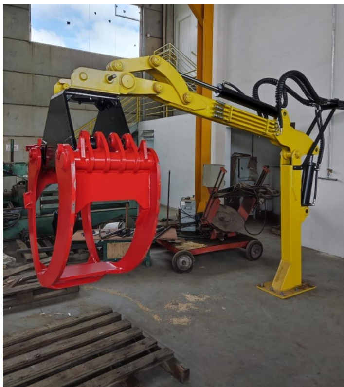
Figura 45 - Garra GJ 800r em montagem.
