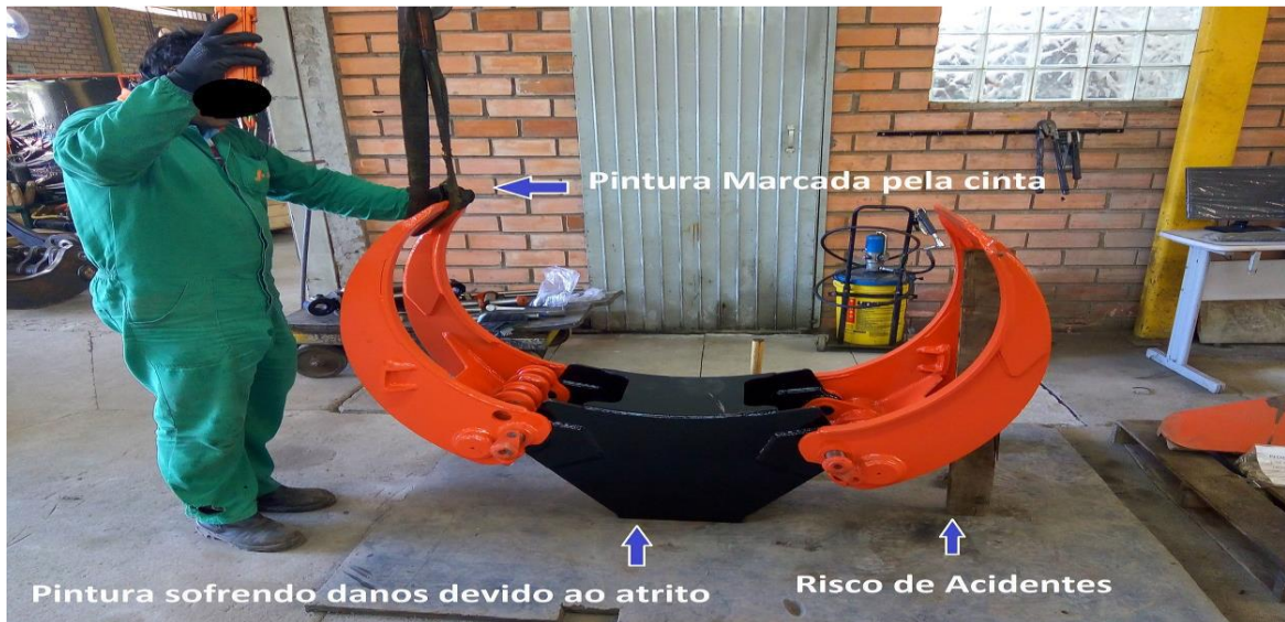
Figura 16 - Evidências de risco de acidentes e danos a pintura.
