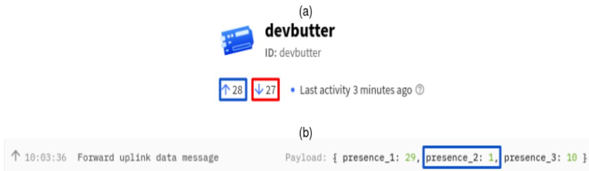
Figura 40. Painel do Network Server , The Things Stack: (a) valor dentro do contorno azul são as mensagens uplink recebidas e o vermelho as mensagens downlink de confirmação enviadas; (b) conteúdo da mensagem enviada e no retângulo azul, as mensagens downlink recebidas.
