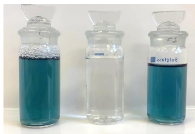
Figura 11: Correntes de alimentação (à esquerda), permeado (imagem central) e rejeito (à direita) do processo de osmose inversa utilizado na recuperação do permeado da ultrafiltração do extrato de ficocianina.
