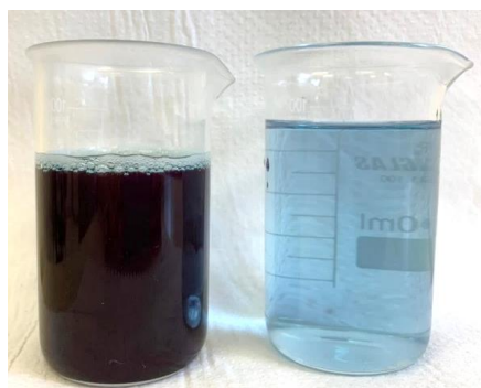
Figura 10: Ficocianina concentrada (à esquerda) e permeado (à direita) da ultrafiltração à pressão de 150 kPa (1,5 bar).
