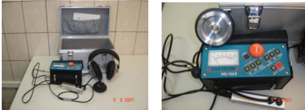
Figuras 3.9 – Geofone Eletrônico.
