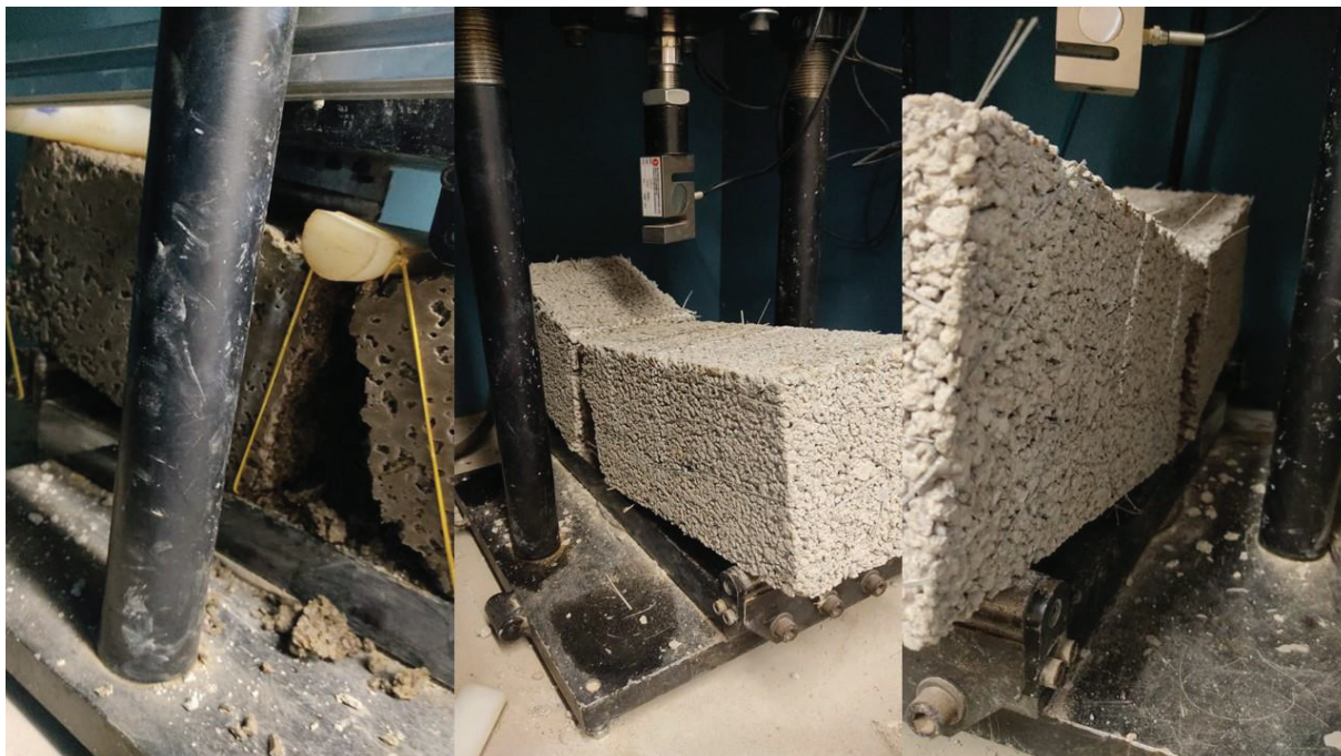
Figura 41 - Rompimento da vigota no terço médio
