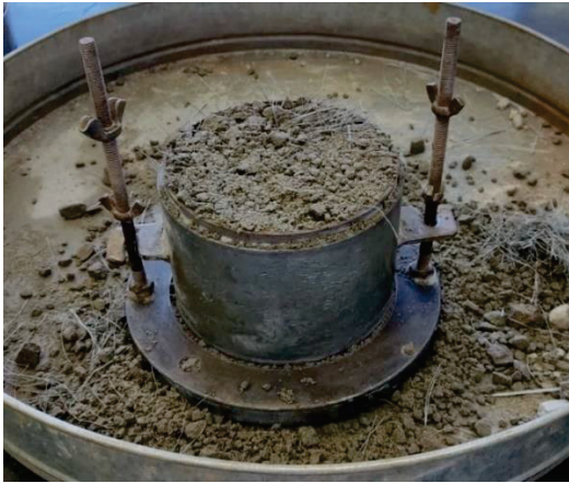
Figura 27 - Cilindro após compactação
