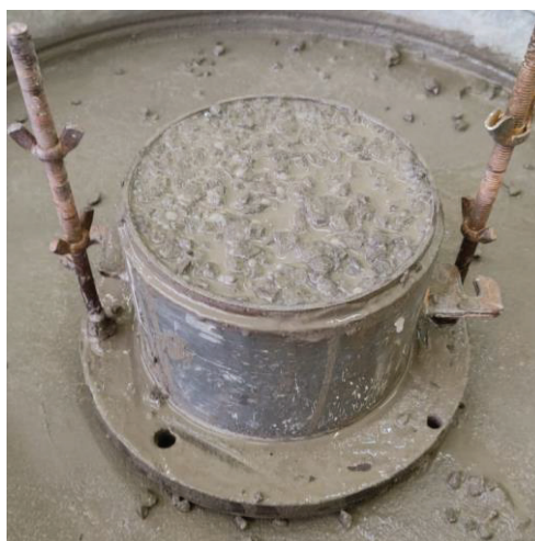
Figura 26 - Exsudação da mistura na compactação
