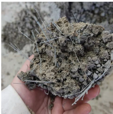
Figura 33: Ruptura do CP com macrofibra
