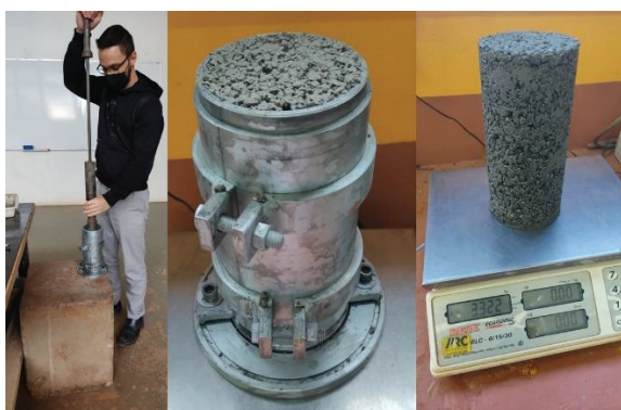
Figura 30: Moldagem dos Corpos de Prova
