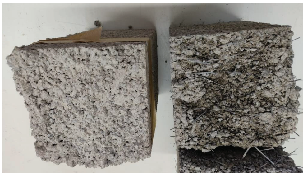
Figura 38 - Vigas rompidas no ensaio de flexo tração estática
