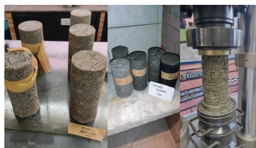
Figura 31 – Capeamento e armazenamento dos CPs na câmara úmida, rompimento com neoprene
