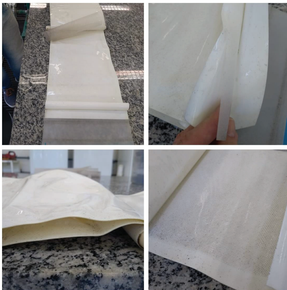
Figura 7: membrana de OI desconstruída para posterior análise.
