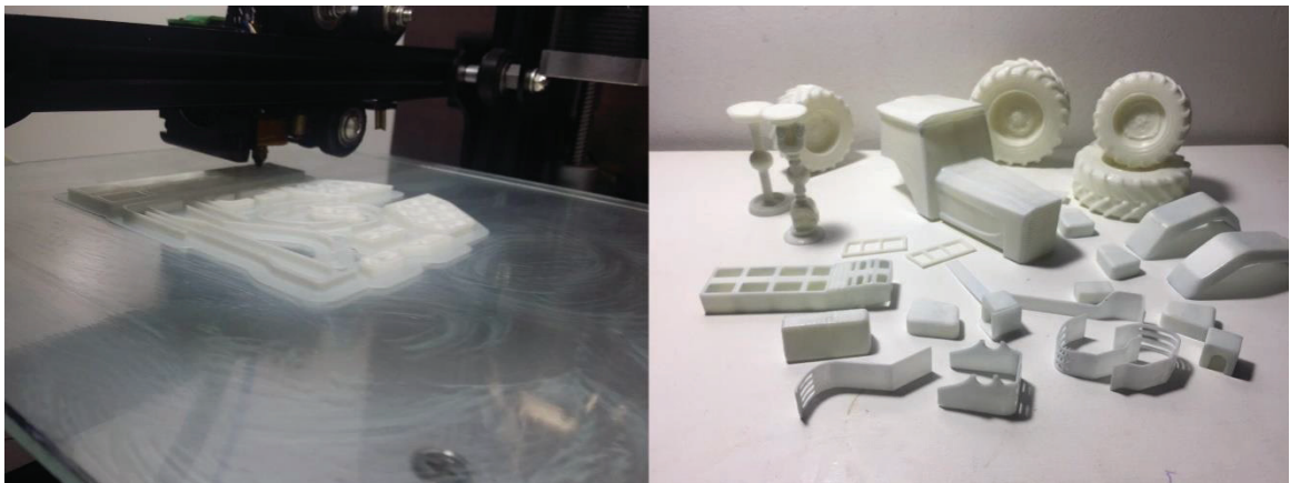
Figura 30 – Processo de impressão das peças
