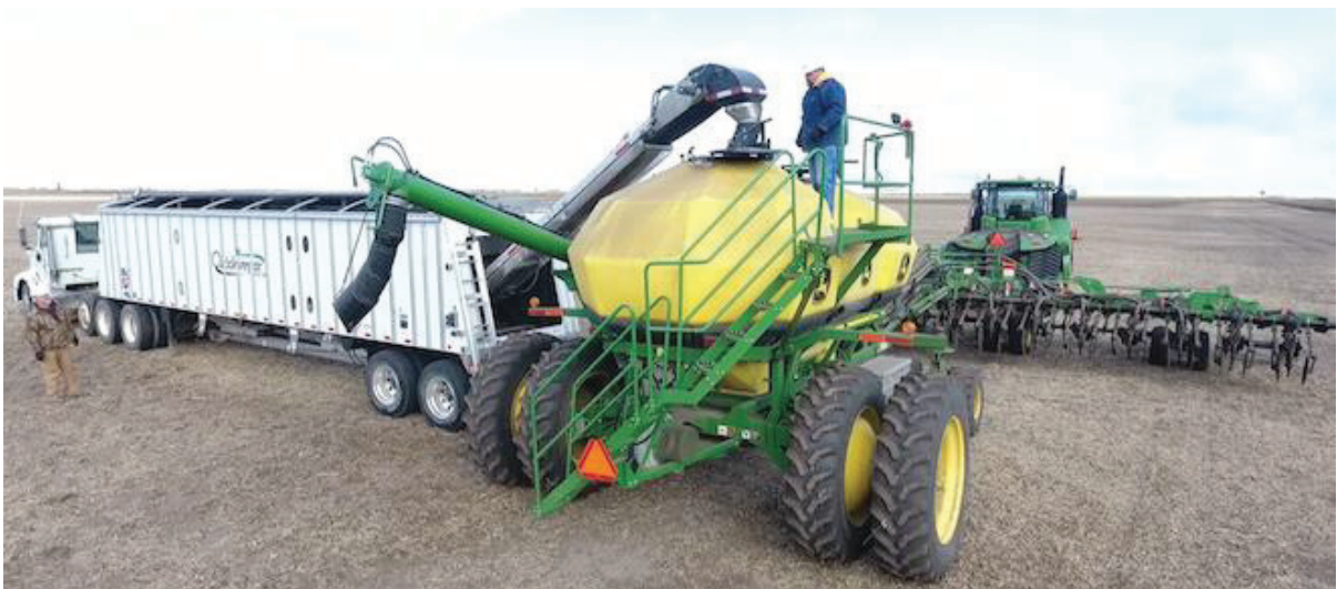
Figura 20 - Equipamento da empresa Quickveyor abastecendo uma plantadora
