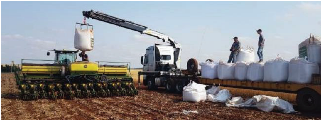
Figura 17 - Guindaste veicular na operação de abastecimento de fertilizantes
