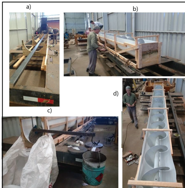
Figura 25 - Ensaio de torque na helicoide
