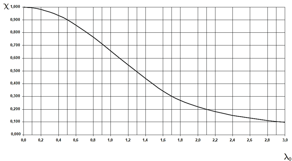
Figura 34: Relação entre o fator de redução ( \chi ) e o índice de esbeltez reduzido ( \lambda_0 ).
