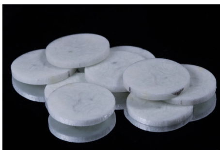
Figura 11 - Amostras confeccionadas com 1.2mm de espessura para o ensaio de resistência à flexão biaxial.
