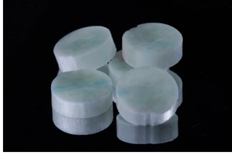
Figura 7 - Amostras confeccionadas com 4mm de espessura para o ensaio de microdureza Knoop.
