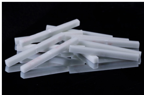
Figura 9 - Barras de CRFV's confeccionadas para o ensaio de resistência à flexão por 3 pontos. (25x2x2mm)
