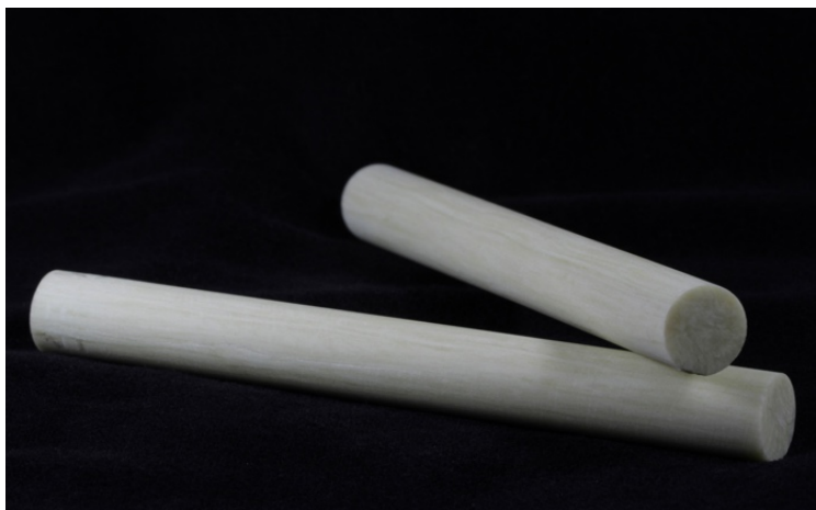
Figura 3 – Barras circulares de CRFV com \approx 12.7\text{mm} de diâmetro.
