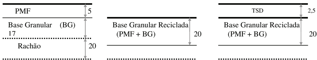
Figura 47 – Estrutura do trecho TR02 antes e após a restauração
