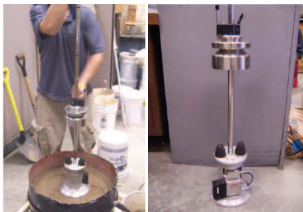
Figura 29 – Ensaio LWD e equipamento LWD
