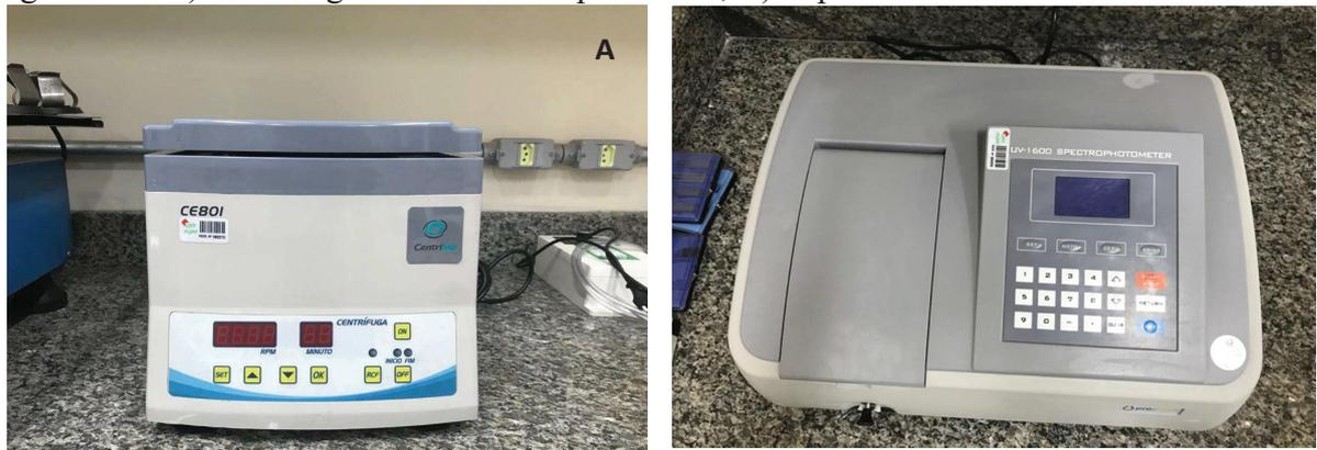
Com relação à espectrofotometria – ou seja, o método utilizado para medir o quanto uma substância química absorve de luz medindo a intensidade quando um feixe de luz passa através do soluto da amostra –, utilizou-se o espectrofotômetro (Figura 36/B), e, para a análise, foram considerados a curva de calibração (Figura 37), a equação da reta e o valor de ajuste ao modelo ( $R^2$ ) para o PCP nos diferentes comprimentos de onda testados.
