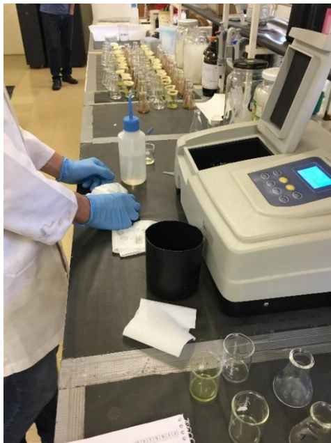
Figura 3 - Leitura da concentração de p-nitrofenol em espectrofotômetro utilizando o método de colorimetria.
