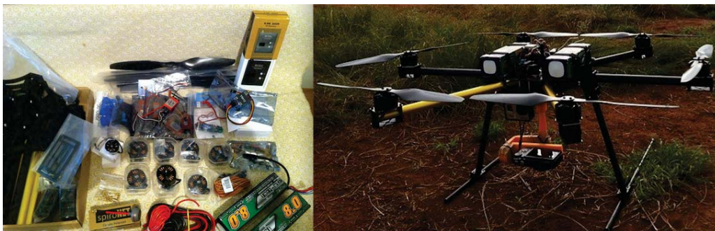
Figura 17. Na esquerda os componentes utilizados para a montagem e na direita o VANT montado.
