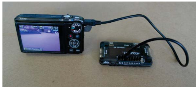
Figura 16. Cabo mini-usb para conectar a câmera com o ArduPilot [104].
