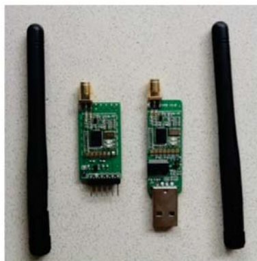
Figura 13. Kit para telemetria open source 915MHz modelo 3DR Radio Set desenvolvido pela empresa 3DR [100].
