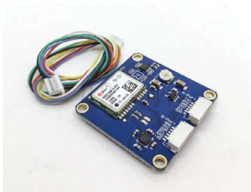
Figura 7. Módulo GPS uBlox 6M utilizado em conjunto com o ArduPilot para possibilitar voos autônomos [94].
