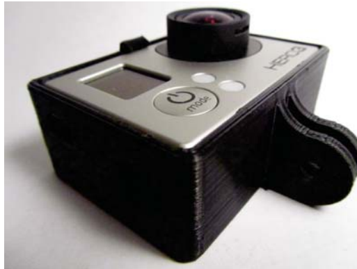
Figura 12. Suporte para GoPro construído em material plástico utilizando uma impressora 3D [101].
