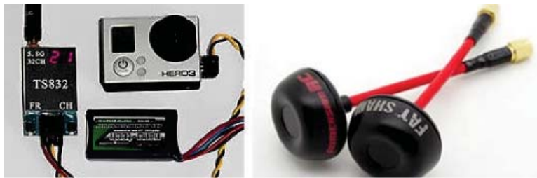
Figura 10. Câmera GoPro Hero 3 conectada ao transmissor Boscam 5.8GHz e antenas Fast Shark [98].
