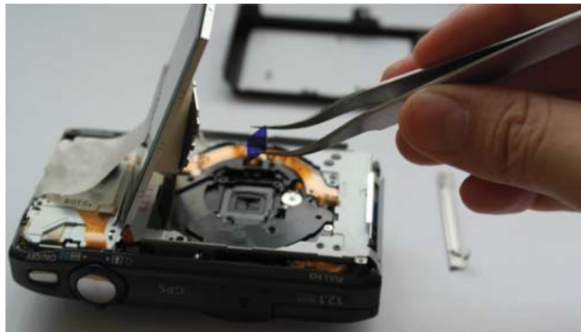
Figura 14. Procedimento para substituição do filtro RGB da câmera Canon SX260HS [63].
