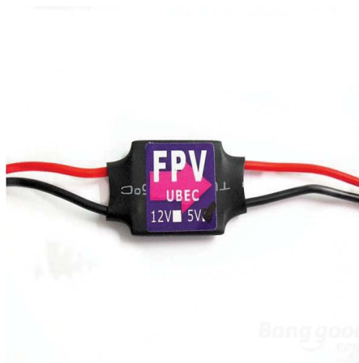
Figura 11. Universal Battery Eliminator Circuit (UBEC) utilizado para reduzir a voltagem da bateria e alimentar o transmissor FPV.
