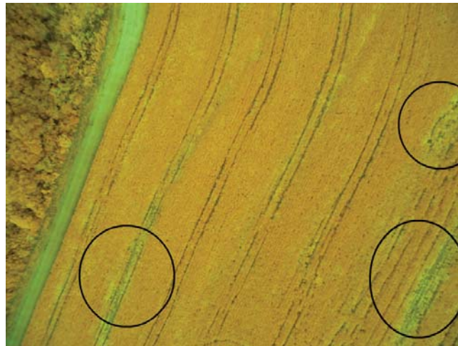
Figura 20. Imagem capturada de uma lavoura de soja em Passo Fundo (-28.19, -52.32), apresentando manchas e danos causados provavelmente por veículos que entram no campo. As marcações em preto indicam alguns destes pontos.
