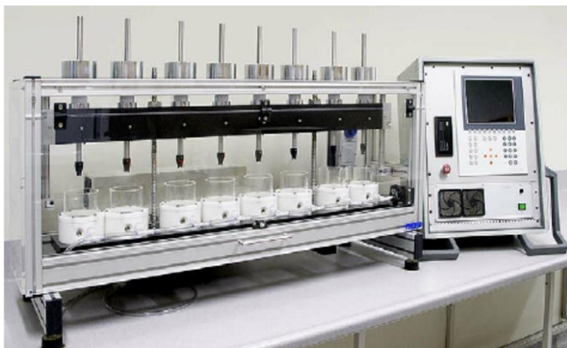
Figura 7 – Chewing Simulator CS-4.8.
