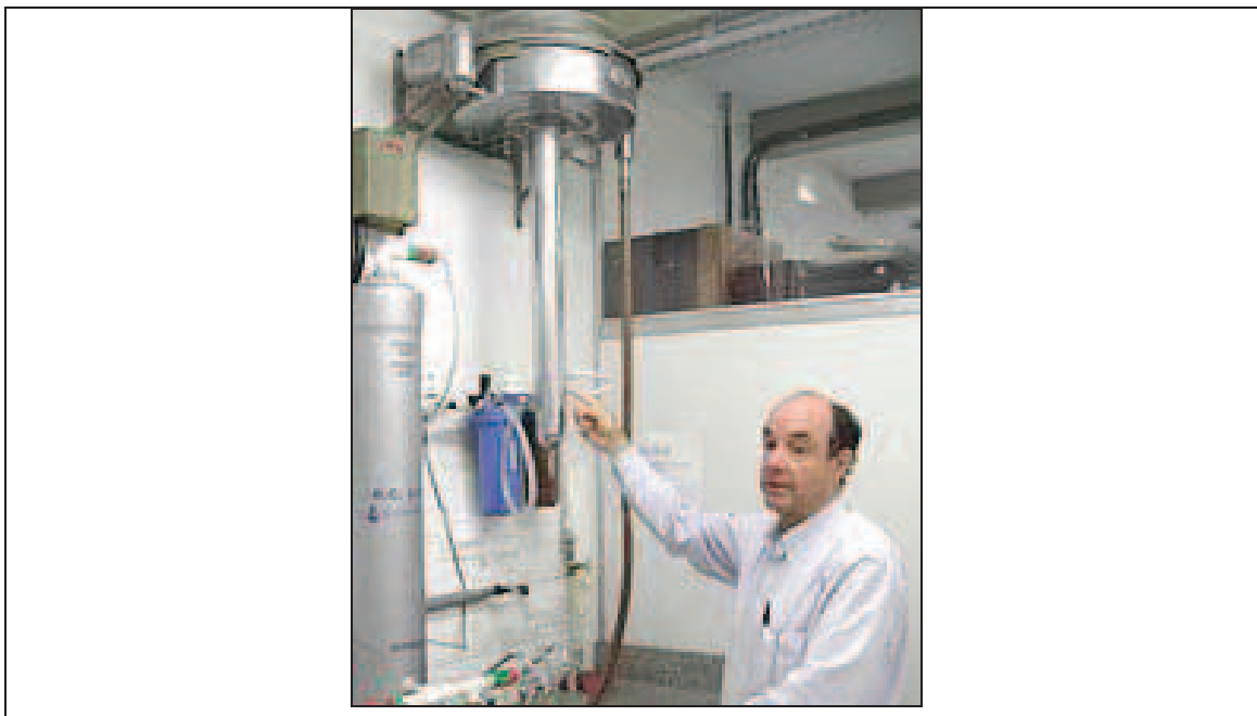
Figura 7: Sistema de destilação e deionização.
