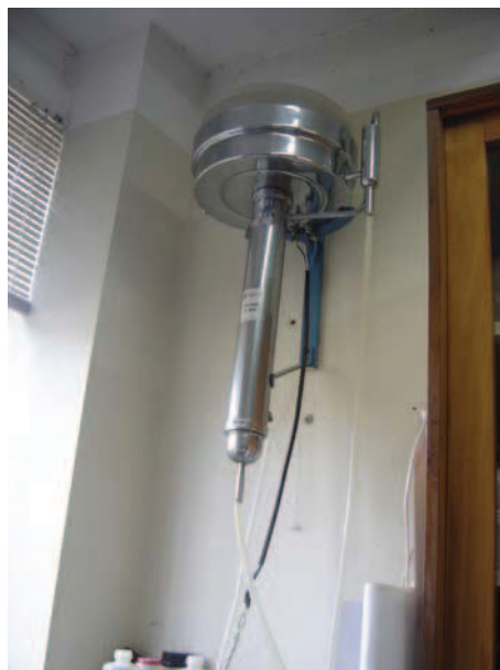
Figura 23: Destilador localizado no laboratório de Preparações – Curso de Química – ICEG
