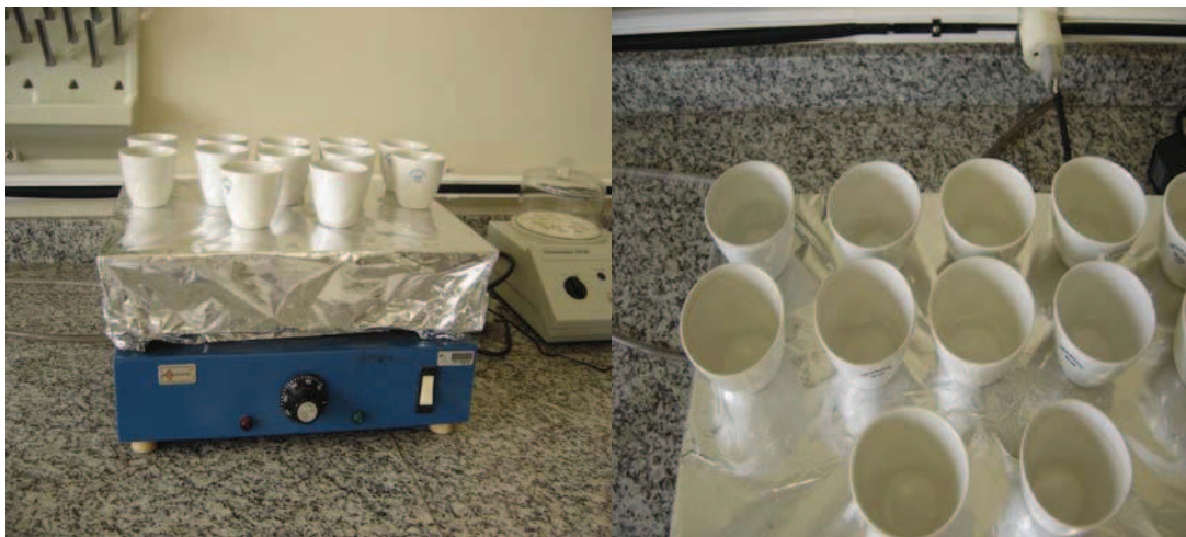
Figura 11: Equipamento para análise de sólidos totais.
