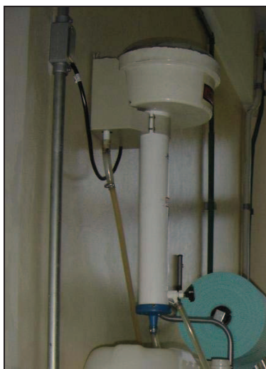
Figura 17: Destilador do Laboratório de Microbiologia – Engenharia de Alimentos – FEAR
