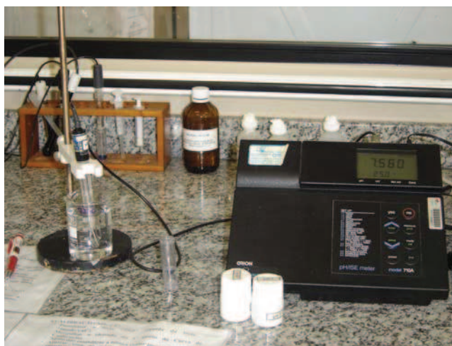
Figura 09: Ensaio do pH em amostras do efluente.
