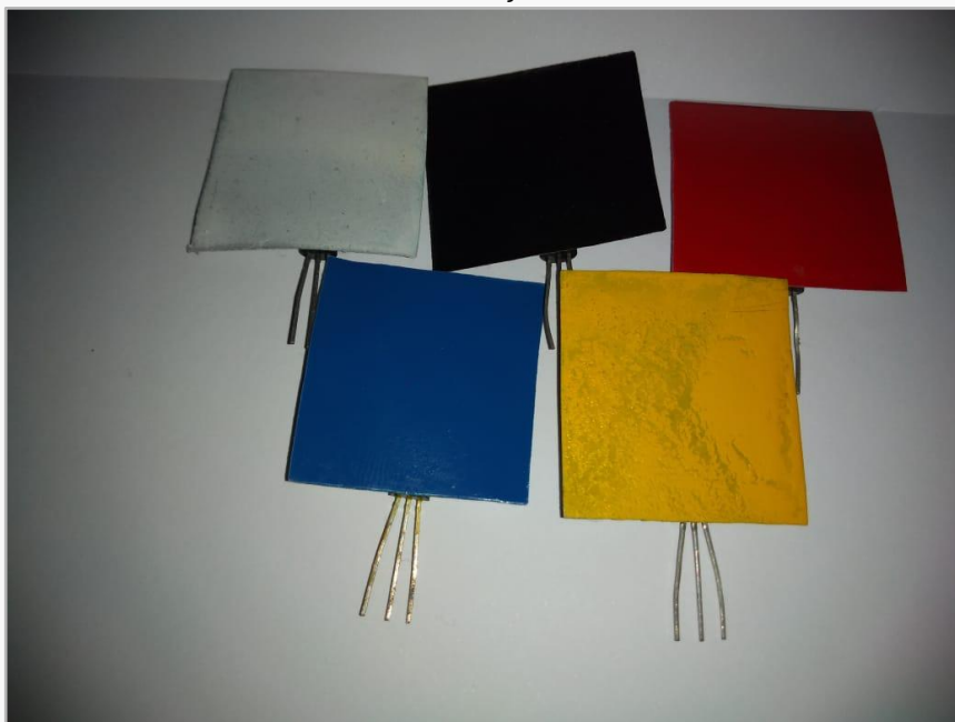
Figura 03: Sensores LM35 com placas coloridas para aferição do processo de Transmissão de Calor por Irradiação
