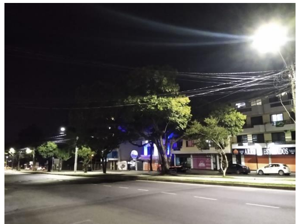
B) Ponto de interferência da vegetação com a iluminação
