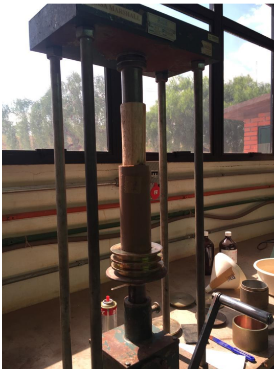
Figura 11 - Moldagem dos corpos de prova em prensa hidráulica
