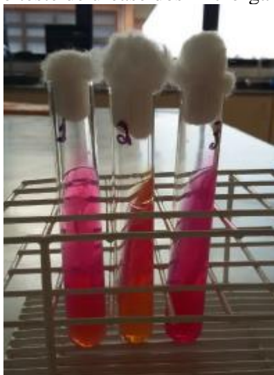
Figura 9 - Resultado do teste de urease dos microrganismos isolados do solo
