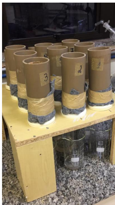
Figura 13 - Esquema para percolação da solução biocimentante nos corpos de prova
