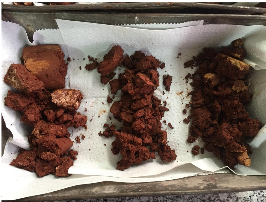
Figura 33 - Corpo de prova exumado em terço superior, médio e inferior
