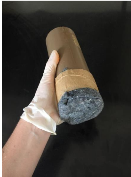
Figura 12 – Geotêxtil para proteção da parte inferior do corpo de prova
