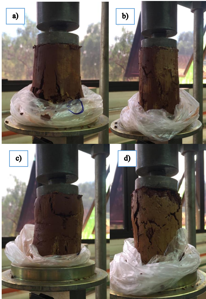
Figura 31 - Forma de ruptura dos corpos de prova: a) CP3; b) CP6; c) CP9 e d) CP20
