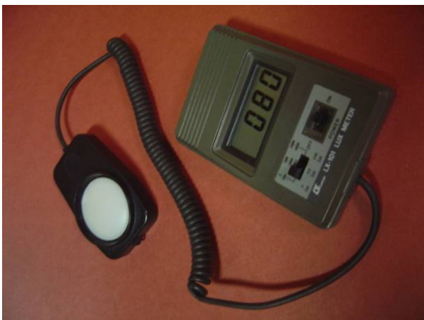
Figura 9 – Luxímetro digital com sonda foto sensível de diodo de silício.
