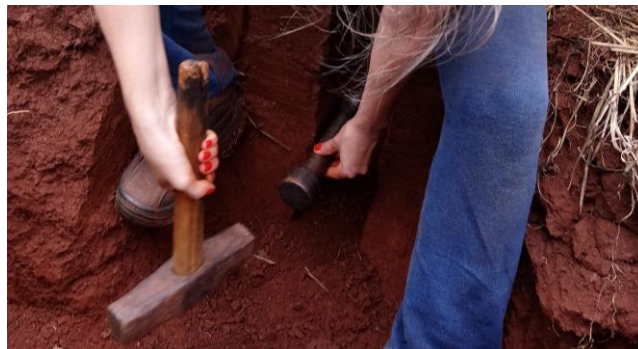
Figura 3 – Coleta de solo com estrutura preservada com auxílio de um extrator acoplado a cilindros volumétricos.
