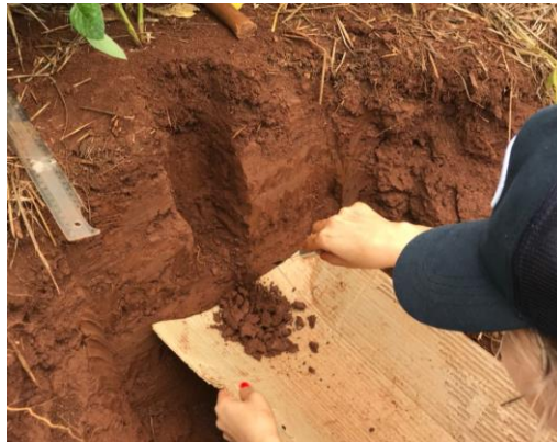
Figura 2 – Coleta de solo na linha de semeadura, para análise química, física e biológica.
