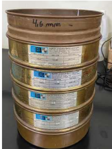
Figura 21 - Peneiras utilizadas na determinação da granulometria dos pellets usados no experimento
