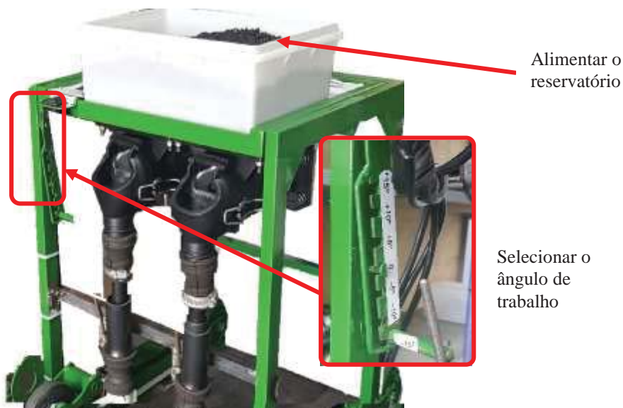
Figura 25 – Bancada usada no experimento com seus respectivos componentes
