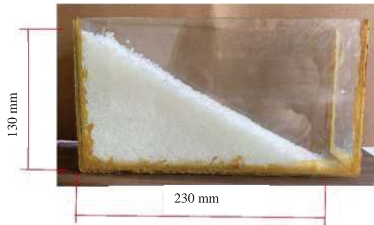
Figura 22 – Reservatório utilizado para medição e cálculo do ângulo de repouso dos pellets
